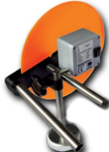
Mit dem RAPID 4 Scheibensskimmer ist das Entfernen von Fremddöl bei Maschinen mit einer Oberfläche von bis zu 2m<sup>2</sup> schnell und einfach. Er ist ein flexibles Gerät, für kleine Maschinen mit offenen Tanks.
