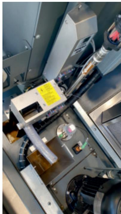
Die automatische Befüllung mit der Füllstandsüberwachung FÜ-1 und die Pflege der Maschine mit Mikro, Rapid und Rubi gehen auch bei engen Platzverhältnissen Hand in Hand.
